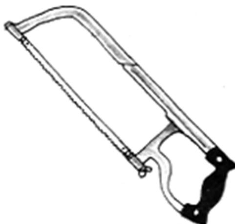
As serras de perfil uniforme necessitam de trava, ou seja, um desvio dos dentes para os lados, alternadamente, para realizar um corte com largura maior que a espessura da lâmina. Caso contrário, a fricção da lâmina contra as paredes do corte causa um esforço enorme, dificultando a operação.
